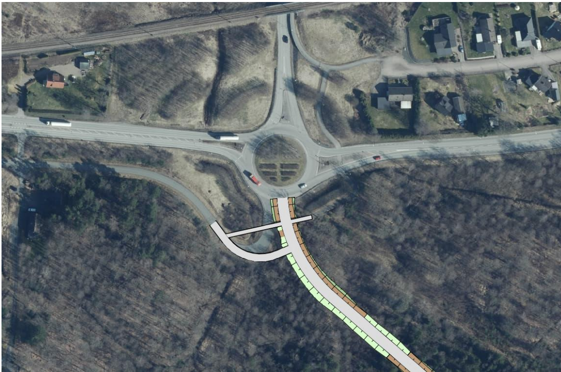
Figur 10. Principskiss över den nya infartens anslutning till cirkulationsplatsen och Vårvägens anslutning till denna.
