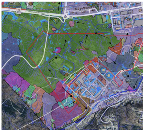
Figur 19. Planområdet markerat med rött och dess avrinningsområden samt flödespilar markerade med svart. Källa: Projektbyggaren i Blekinge, 2024.
