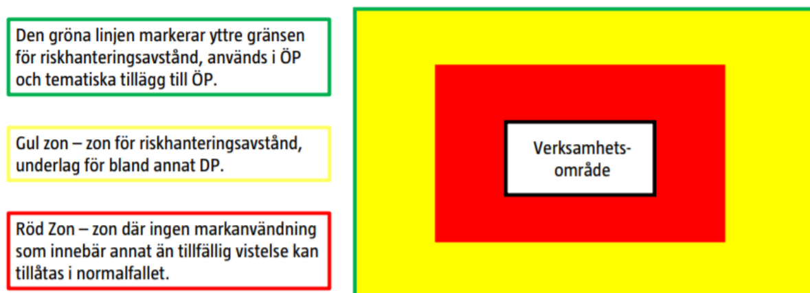
Figur 1. Illustration över riskhanteringsavståndet och tänkt användning för verksamheter som hanterar brandfarliga gaser, brandfarliga vätskor och oxiderande ämnen. Den gröna linjen representerar den yttre gränsen för riskhanteringsavståndet. Olyckor inom verksamheten förväntas ej kunna medföra personskador bortanför grön linje. Vid planläggning inom den gula zonen befinner man sig inom riskhanteringsavståndet vilket kräver att vidare analyser genomförs för att avgöra om tilltänktmarkanvändning är lämplig. Den röda zonen är normalt olämplig att använda för markanvändning som medför stadigvarande vistelse i området [1].
