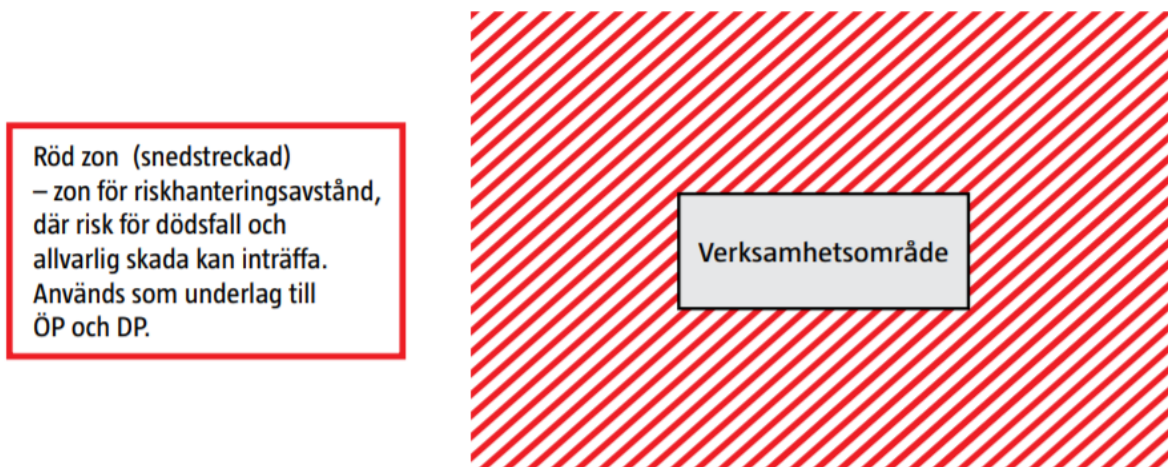
Figur 2. Illustration som visar schabloniserade riskhanteringsavstånd som i vägledningen har angetts som "större än", vilket representeras med en snedstreckad röd zon från fastighetsgräns. Detta gäller för verksamheter som hanterar explosiva varor, giftiga gaser, giftiga ämnen och frätande ämnen. För denna typ av verksamheter bör risken för dödsfall och skada beaktas till angivet riskhanteringsavstånd. I dessa situationer är det särskilt relevant att ta fram ett verksamhetsanpassat riskhanteringsavstånd [1].
