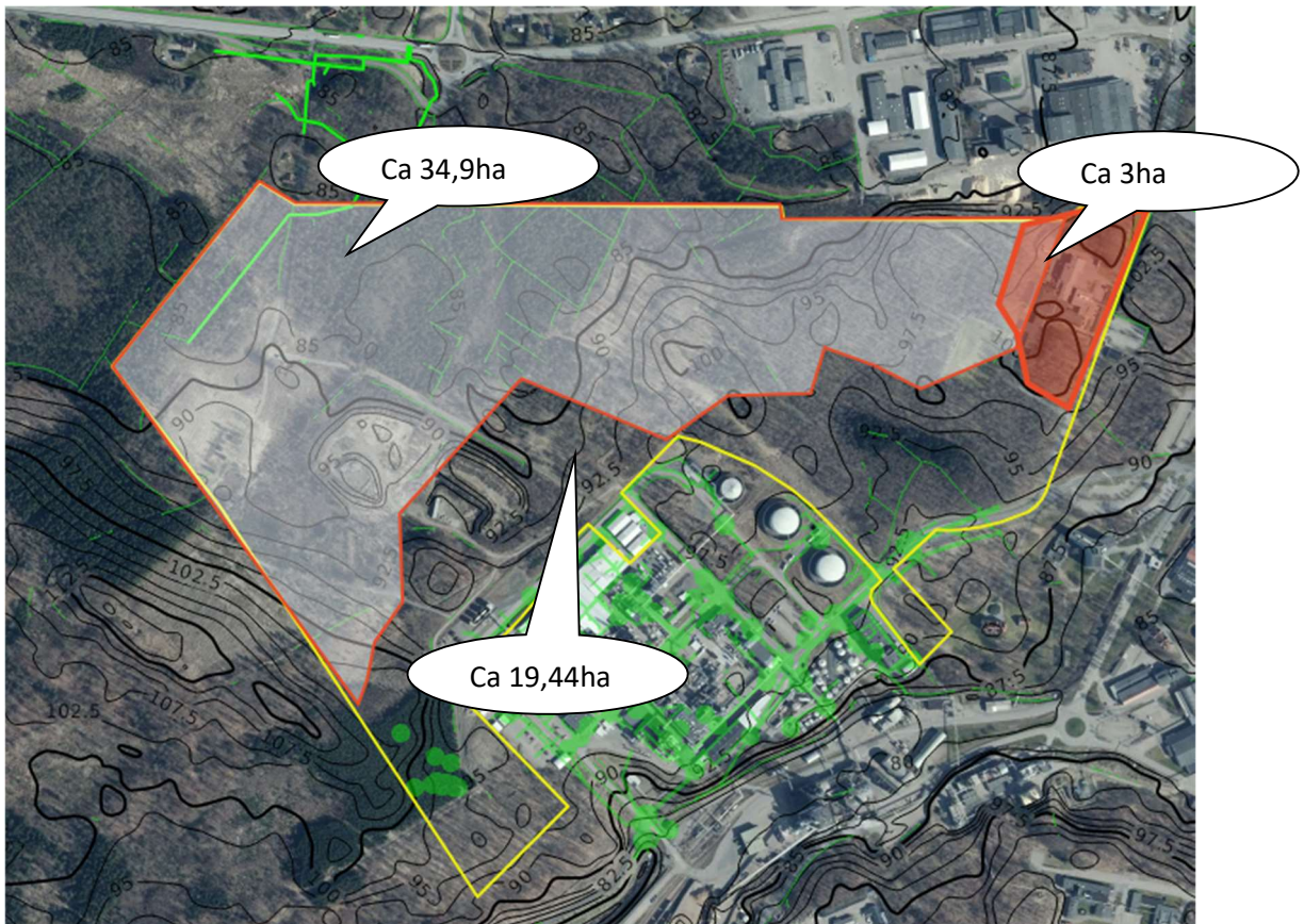
Figur 19: Uppdelning av ytor inom planområdet som leds norr respektive söder ut efter exploatering.
