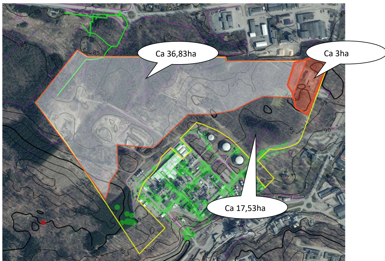
Figur 17: Uppdelning av ytor inom planområdet som leds norr respektive söder ut i befintlig situation.
