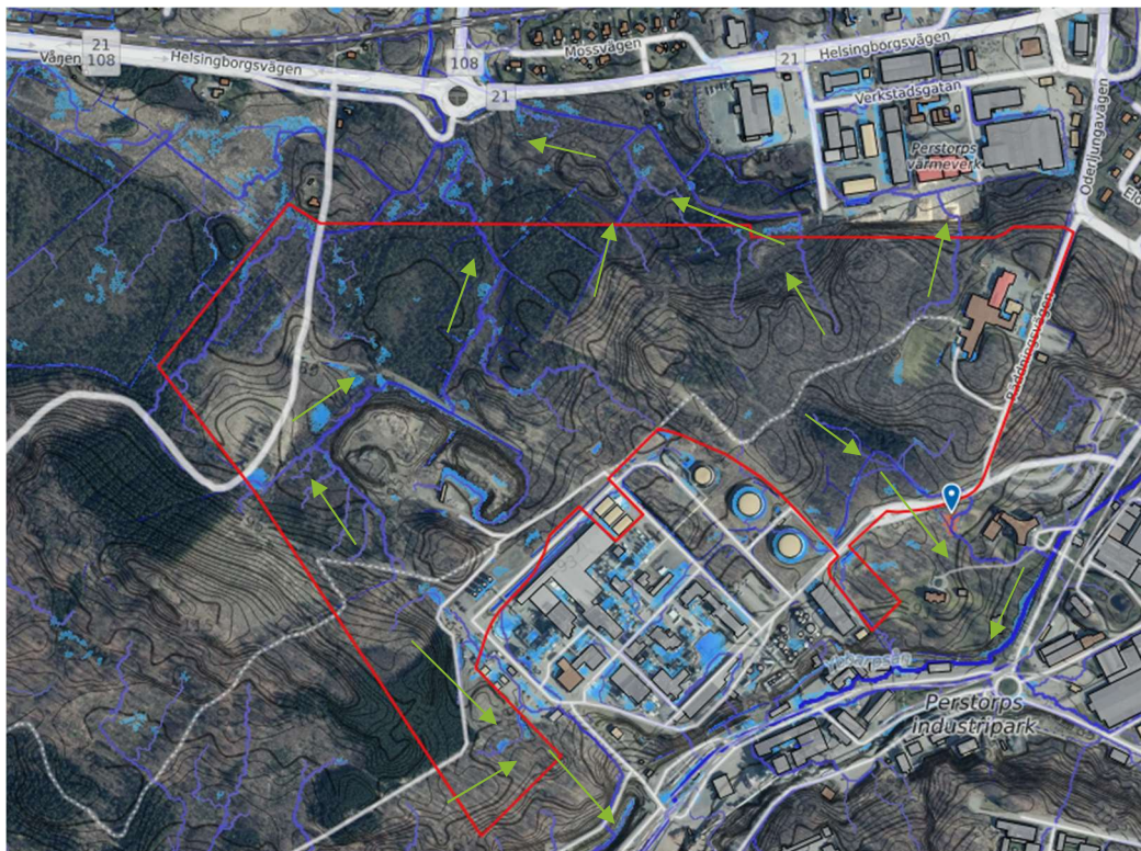
Figur 9: Lågpunkter och rinnvägar markerade med blått. Gröna pilar visar flödesriktningen.
