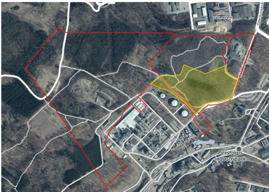
Figur 18: Det gula området i figuren är en del av det södra området som avrinner till anslutningspunkt 2 för dagvattnet.
