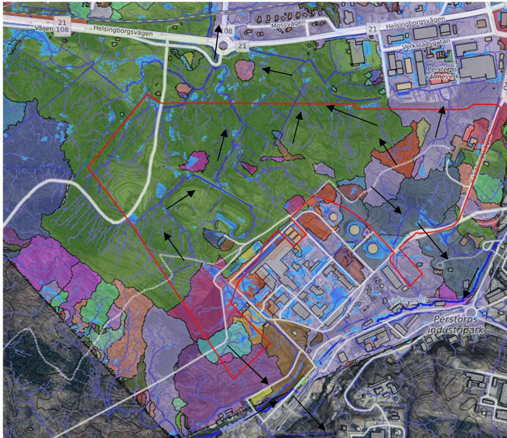
Figur 8: Planområdet markerat med rött och dess avrinningsområden samt flödespilar markerade med svart. (källa: Scalgo Live)
