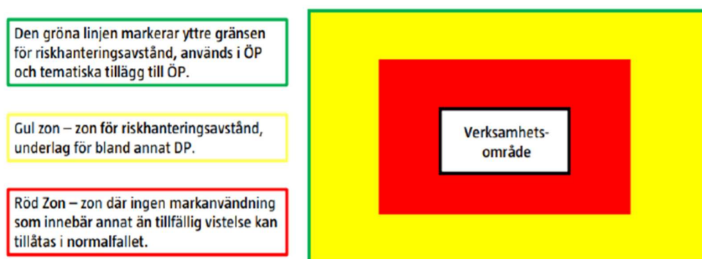
Figur 45. Illustration över riskhanteringsavståndet och tänkt användning för verksamheter som hanterar brandfarliga gaser, brandfarliga vätskor och oxiderande ämnen. Den gröna linjen representerar den yttre gränsen för riskhanteringsavståndet. Olyckor inom verksamheten förväntas ej kunna medföra personskador bortanför grön linje. Vid planläggning inom den gula zonen befinner man sig inom riskhanteringsavståndet vilket kräver att vidare analyser genomförs för att avgöra om tilltänkt markanvändning är lämplig. Den röda zonen är normalt olämplig att använda för markanvändning som medför stadigvarande vistelse i området
